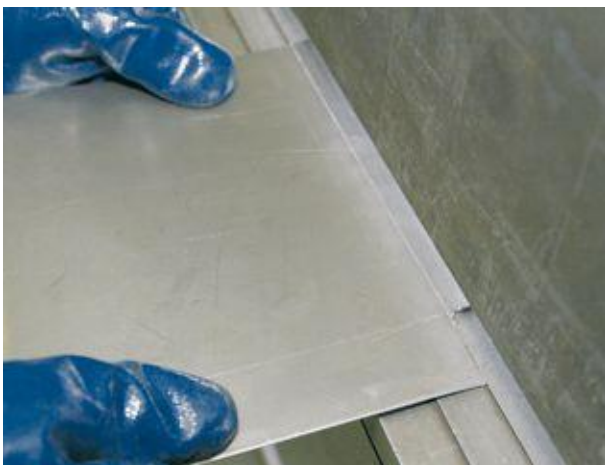
Figuur 5-6: Juiste instelling van de buigbalk en liniaal
