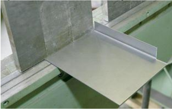
Figuur 5-7: Gedeelde liniaal met vingers
